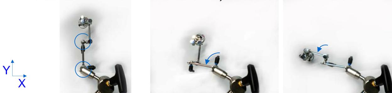
ストローク調整 1 及び 2 でストローク方向 (Z) の調整を行い、プローブを基板に近づけてノブで固定します。
